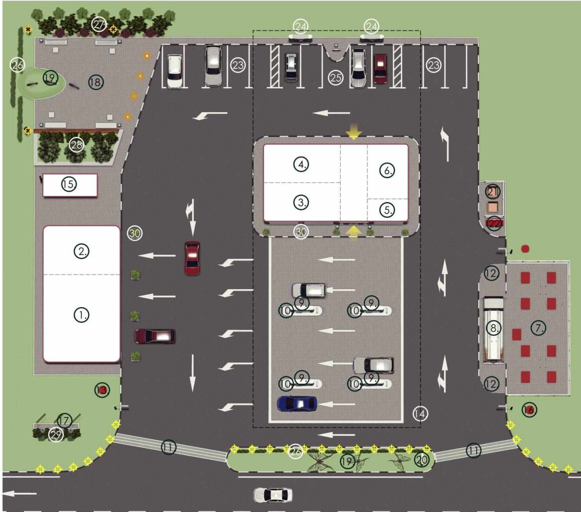
Тип 2. Схема планировочной организации автомобильно-заправочного комплекса
