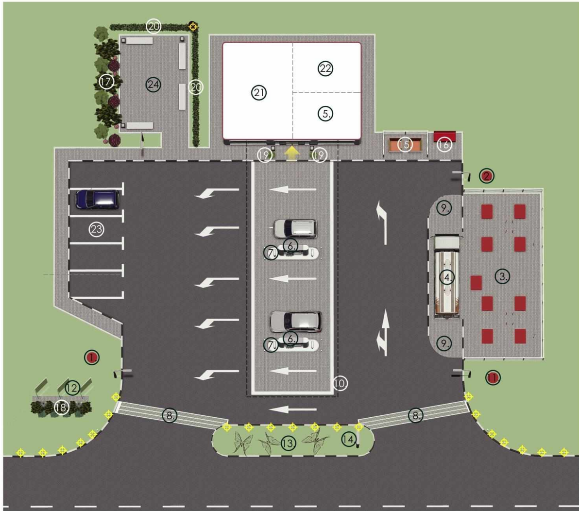
Тип 1.2. Схема планировочной организации придорожной автомобильно-заправочной станции
